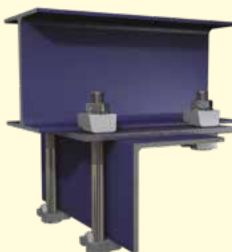
Połączenie kątownika poniżej dwuteownika pod kątem 90 stopni.
