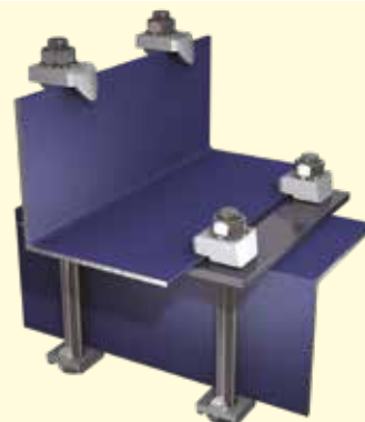
Połączenie 2 kątowników pod kątem 90 stopni.
