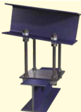
Podkładki sferyczne użyte do podwieszenia na skośnej belce poziomego dwuteownika.
