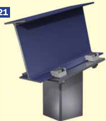
Geneigte Verbindung eines Trägers an einem Hohlprofil
