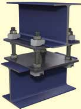
Um 90 Grad versetzte Trägerverbindung mittels Montageplatten und Gewindestangen zur Schaffung eines Freiraumes
