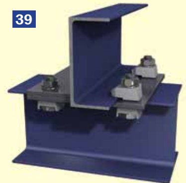
U-Träger um 90° versetzt an oberem Flansch fixiert
