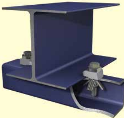
Um 90° versetztes Hohlprofil unter H-Träger
