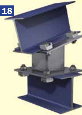
Um 90 Grad versetzte Trägerverbindung mit geneigtem Montagegestützen
