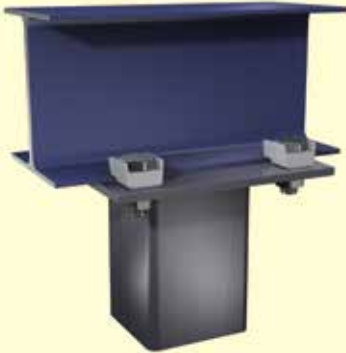
Vierkanrohr mit Kopfplatte an Träger
