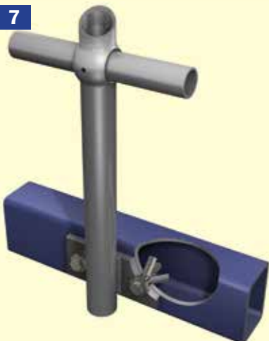
Geländer, seitlich an Hohlprofil
