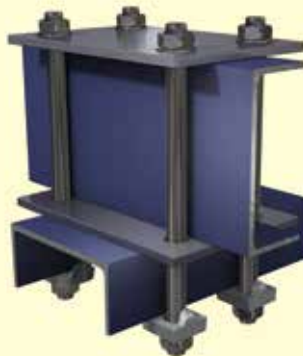
U-Träger um 90° versetzt an U-Träger
