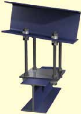
Träger an geneigtem Träger mit Zwischenraum
