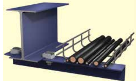
Winkelprofil als Träger für Kabelkanal an Stahlträger
