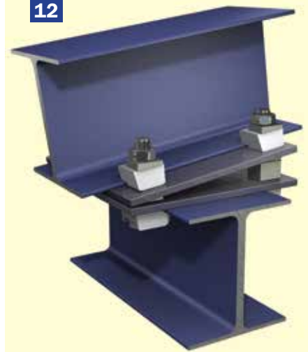
Um 90 Grad versetzte, mittels Distanzstücken geneigte Trägerverbindung
