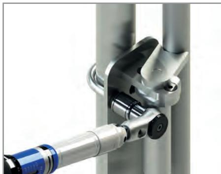
**2.** 用扭力扳手拧紧螺母和U型螺栓，扭矩为25Nm。
