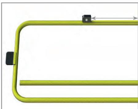
**4.** 拧开顶部与底部管接件上的紧定螺丝，将钢管门从折页装置中拆下来。在安全门的水平位置钢管上量出的距离并做记号。
