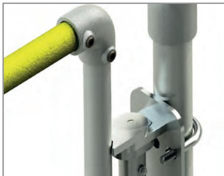
**1.** 将固定板与开口处内表面对齐，插入合适的U型螺栓扣在护栏上，插入固定板上下两处孔眼，并套上垫圈和螺母。
