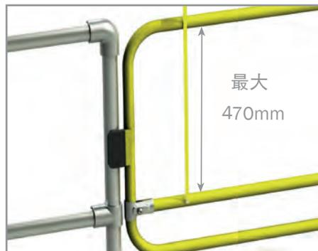
**9.** 确保中间横管安装位置是水平的，并且和顶部距离不超过470mm，管夹扭矩19Nm。
