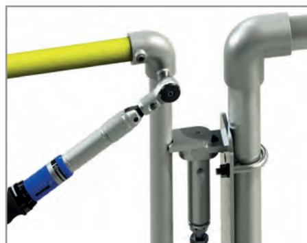
**6.** 将调整后的门复位，使用扭力扳手将紧定螺丝扭紧，扭矩为39Nm。
